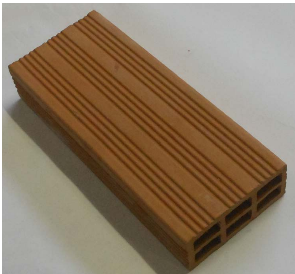
Figura 1. Riproduzione fotografica di un provino tal quale del prodotto "CF06004 – Forato 6x14x33".
