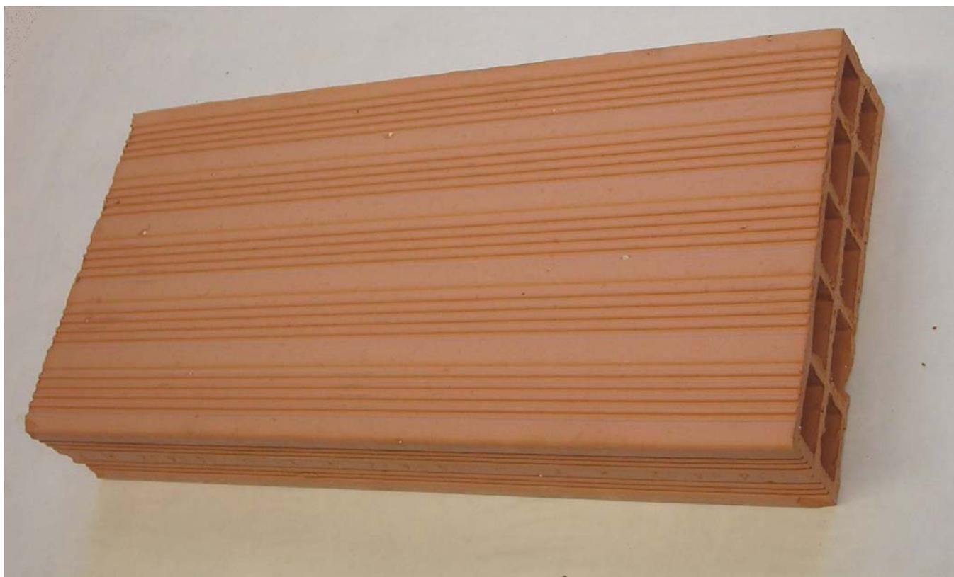
Figura 1. Riproduzione fotografica di un provino tal quale del prodotto "Forato 8x24x50".
